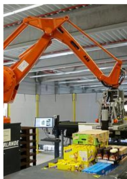
Technik für Filialkommissionierung: Ein Roboter von Vanderlande in Aktion.
